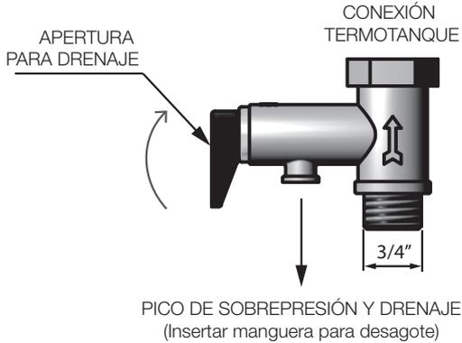
Este tipo de válvulas de alivio es uni-direccional, y su correcta posición con el flujo de agua entrante hacia el termo está señalada con una flecha en el lateral de la misma.
