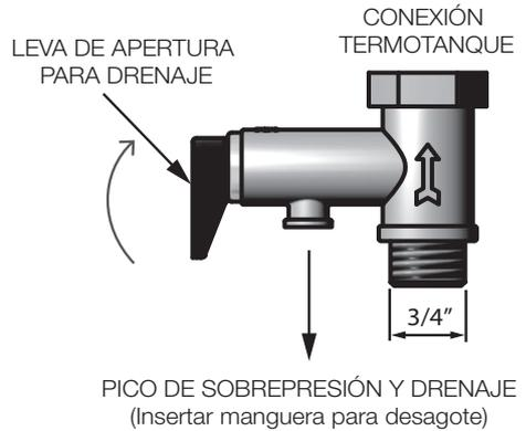
Este tipo de válvulas de alivio es uni-direccional, y su correcta posición con el flujo de agua entrante hacia el termo está señalada con una flecha en el lateral de la misma.
