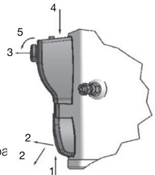
Para el encendido del piloto con una llama auxiliar, se debe desplazar las puertas hacia los costados una vez retirada la consola inferior.
