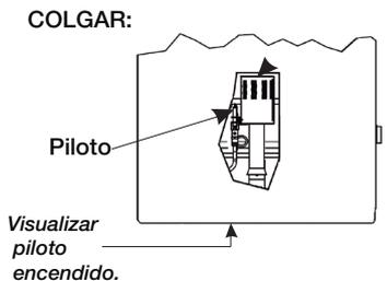
En termotanques de colgar, el encendido se verifica desde la tapa inferior del termotanque. La visibilidad de la llama de este piloto, por su forma de construcción, se encuentra disminuída, ya que el bastidor del mismo oculta parcialmente la llama.
